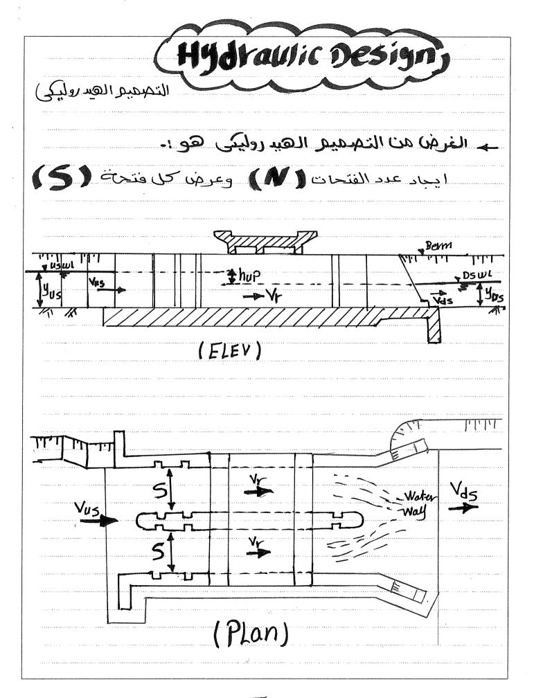
· yos DS water DePth US water DePth i. Yus : VDs DS water velocity Us water velocity : Vus Regulator water velocity Yus = Yos + hup \* ایجاد عدد الفتحات ( ۱۷) وعر من الفتحة ( 5) . (heating UP) se (Check) Joses X Given افعما نصرف عمميمي - Canal Cross section DS the regulator قطاع النوعات فى الـ DS (DS X-setion)
